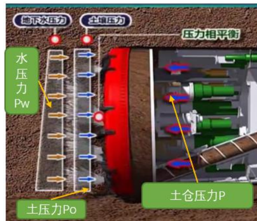
图 2-5 土压平衡盾构原理
